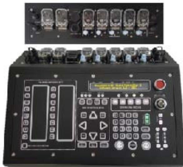
パイロデジタル FC-Aに搭載された5つのネットワークドライブは、各々分離されており打ち上げの際の冗長性を高めています。5つのネットワークドライバーを使用すると別々のネットワークとして使用できますので、複数のフィールドコントローラーを並行して使用する必要はありません。5本のネットワークラインを完全に分離するために、各出力には独自のドライバ電子回路とサーマルサーキットブレーカーが用意されています。パイロデジタルのウェブサイトから5つのネットワークを使用し、FC-Aで同時に打ち上げを行うビデオをご確認ください。
